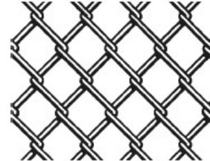
Werkstoff: Draht starkverzinkt gem. DIN/EN 10244-2 Class A
